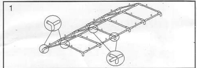
Nun Zeltplane (Dachbespannung) über das Rahmengestänge ziehen und zunächst nur an den Giebelseiten und allen Aussenecken mit Spanngummis durch Ringösen am Gestänge befestigen.
