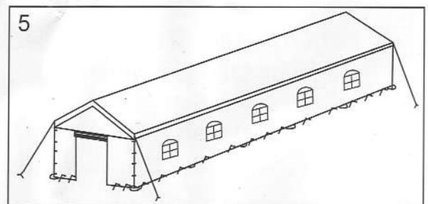
Anschließend die Längseitenwände (10m lang) mit Klettverschlußbändern wie abgebildet am Rahmengestänge befestigen. Zelt ausrichten und alle Fussteller mit den Bodennägeln im Erdreich verankern. Alle Seitenwände ebenfalls mit Bodennägeln durch die entsprechenden Ringösen im Erdreich festspannen.
